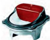
Heizbares Tränkebecken für Offenstallung (Mod. 43A). Geeignet für Rinder, Schweine und Schafe. Schale aus Gusseisen, innen emailliert mit Schwimmerventil. Frostsicher bis ca. -20°C. Anschluss R 1/2 von unten.
